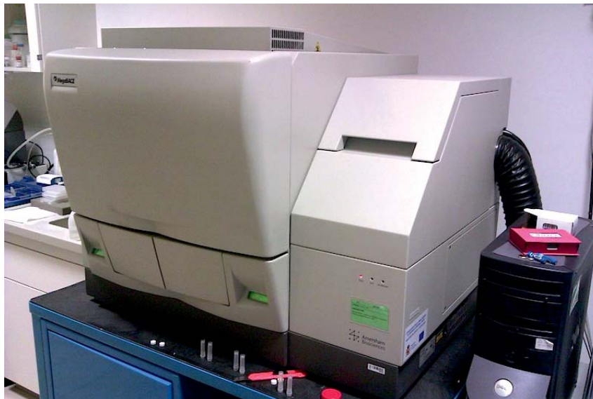
Figura 4. Secuenciador MEGABACE 500 del Servicio de Secuenciación de la Universidad de León.
