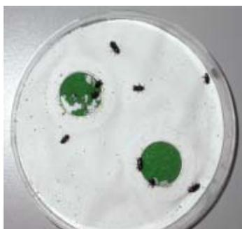
**Figura 3.** Ensayo de doble elección en el que se observa una mayor alimentación del escolítido en el disco foliar no impregnado con juglona (derecha) (Pajares et al., 2004).
